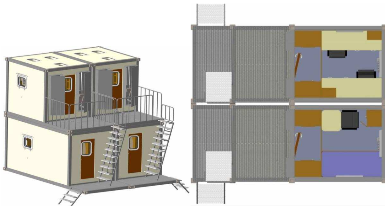
Рисунок 2.7 – Общий вид (слева) и план (справа) лабораторно-жилого двухъярусного модуля-блока
